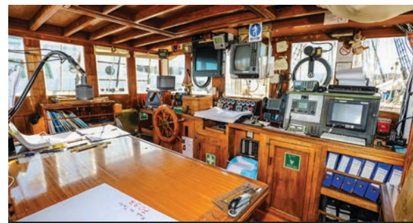
La timonerie : cette structure, édifée au début des années 80, abrite l'ensemble des instruments nécessaires à la navigation et aux transmissions, une table à carte, une collection de documents nautiques et la barre de secours.
