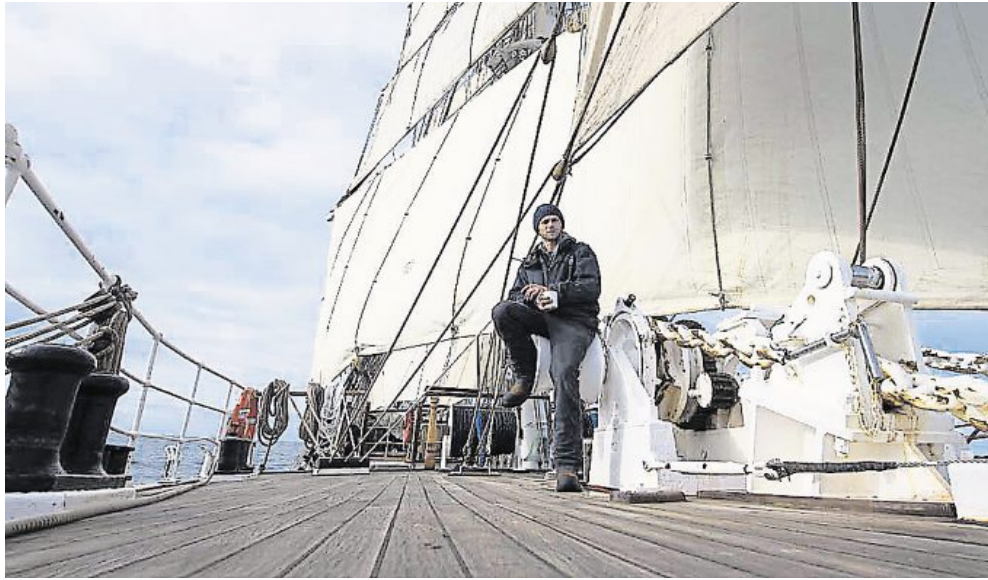
Pont. Il a été refait et imperméabilisé lors de l'hivernage 2015-2016. Photos PO-Olivier Lanrivain
