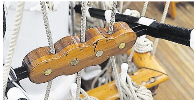
Poulie-violon. Une pièce unique réalisée sur mesure par le maître charpentier, Gaël Hubert.
